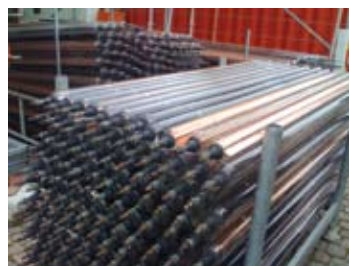
Système tubes sous vide (source CAUE60)
