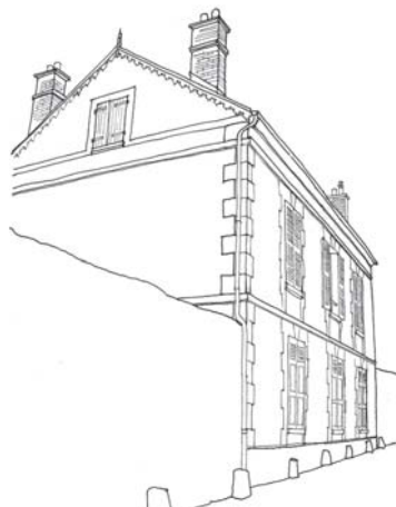
Châînages en pierre de taille et bandeaux structurent les murs des façades des maisons de village
