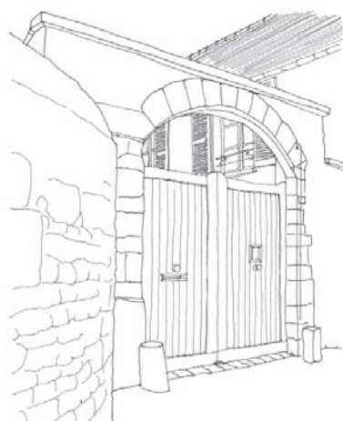
Porche cintré sur porte charretière à deux vantaux en bois plein, mur et chasse-roues en pierre
