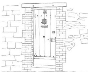
Portillon en bois surmonté d'un linteau métallique avec des jambages en brique
