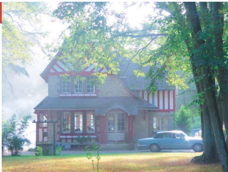
Les constructions 1925-1945 présentent souvent une façade ouvragée éclairée par des baies de proportions variées et une entrée abritée par un auvent ou une marquise. Les combles offrent souvent des volumes habités et éclairés par différents châssis et lucarnes. Des débords de toit soutenus de jambettes en bois protègent les murs des eaux de ruissellement.
