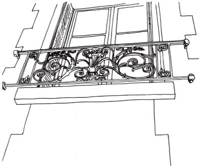
Appui de fenêtre en pierre, garde-corps en ferronnerie ouvragée, persiennes métalliques
