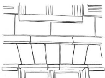
Bandeau, encadrement, linteau, appui de fenêtre en pierre de taille structurant des éléments de façade
