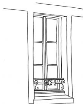
Fenêtre traditionnelle (plus haute que large) avec un encadrement en enduit lissé
