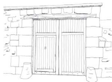
Porche sur porte charretière à deux vantaux en bois plein, mur et chausse-pieds en pierre
