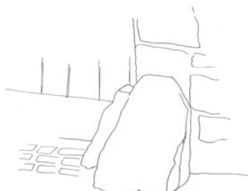
Borne de pierre faisant office de chausse-pied protégeant l'arête du mur de clôture.
