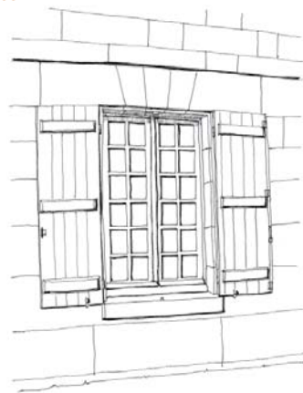
Dans un mur en pierre de taille, une fenêtre haute à petits bois - configuration très fréquente à Rhuis
