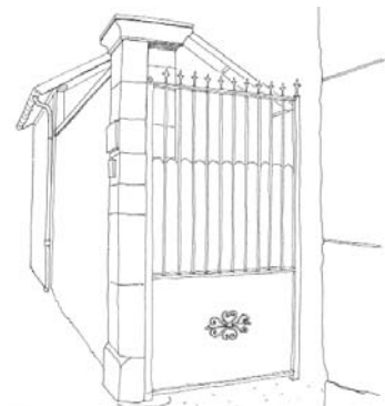
Mur et pile maçonnés avec portail en ferronnerie disposé en feuillure
