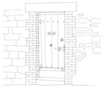
Portillon en bois surmonté d'un linteau en pierre posé sur des jambages en brique
