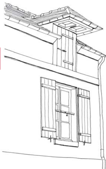
Lucarne à engranger engagée dans le toit, pour accès à l'étage dit "à encuvement"
