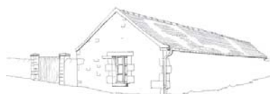
Longère en angle de parcelle, dans le prolongement des murs de clôture. On y accède par un portail sur cour ; sa seule ouverture, en pignon, est désaxée par rapport au faîtage.
