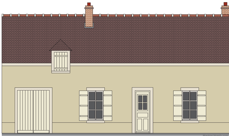
Les linteaux et appuis des fenêtres sont alignés. Les ouvertures en pignon ne sont jamais dans l'axe du faîtage.
