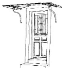
Porte d'entrée en bois avec la partie supérieure vitrée et protégée par une ferronnerie surmontée d'une marquise
