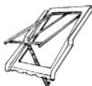
Châssis à tabatière appelé aussi vasistas, c'est une fenêtre pour toit en pente, à cadre léger en tôle galvanisée dont l'ouvrant est à projection
