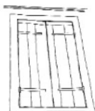
Volets en bois plein avec éléments de ferrures et encadrement en enduit lissé
