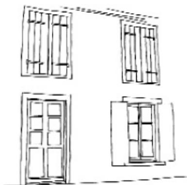
Les tableaux en moellon des fenêtres sont traités de la même façon que le mur de façade, soit enduits, soit rejointoyés à pierre vue. Ceux en pierre de taille sont simplement rejointoyés
