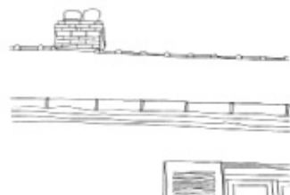
Façade avec peu de modénature : corniche en liaison avec l'enduit, pas d'encadrement de fenêtres
