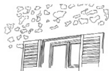
Les tableaux des fenêtres sont traitées de la même façon que le mur de façade, soit enduits, soit rejointoyés à pierre vue
