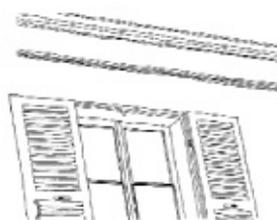
Les tableaux en moellon des fenêtres sont traités de la même façon que le mur de façade, soit enduits, soit rejointoyés à pierre vue. Les tableaux en pierre de taille sont simplement rejointoyés
