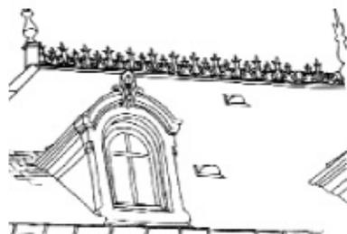
Lucarne cintrée en zinc, lucarne engagée dans le mur (0,90m x 2m) maçonnée avec toiture à 3 pans
