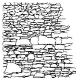
Mur de pierre sèche, monté sans mortier avec un appareillage restant apparent
