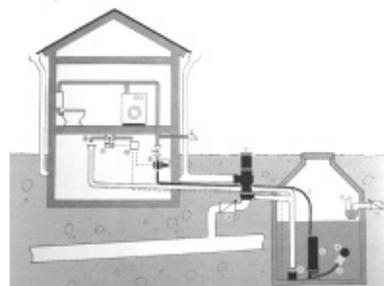
Schéma d'une installation de récupération des eaux de pluie avec citerne enterrée et pompe immergée
