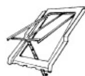
Chassis à tabatière appelé aussi vasistas, c'est la fenêtre de toit traditionnelle présente sur le bâti ancien, à cadre léger en tôle galvanisée dont l'ouvrant est à projection
