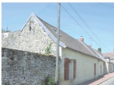
La construction forme un parallépipède rectangle étroit et de plain-pied, surmonté d'un toit à deux pentes à 45°, encadré par des souches de cheminées établies dans le prolongement des pignons. Sa hauteur au faîtage est comprise entre 6 et 7 mètres depuis le sol. Sa longueur varie de 13 à 24 mètres et sa largeur de 5 à 7 mètres. Des annexes peuvent être accolées à ce volume principal.
