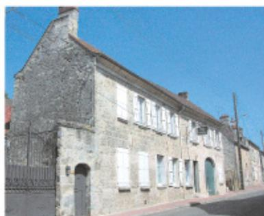
La construction forme un parallélogramme rectangle de dimensions importantes tant en hauteur qu'en longueur sur rue. Elle est surmontée d'un toit à deux pentes à 45° encadré par des souches de cheminées établies dans le prolongement des pignons. Sa hauteur au faîtage est comprise entre 12 et 15 mètres depuis le sol. Sa longueur varie de 13 à 24 mètres et sa largeur de 5 à 7 mètres.
