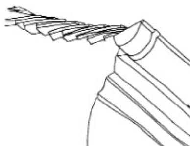
Gouttière en zinc avec un coyau au profil courbe servant à couvrir la corniche et à éloigner les eaux du mur
