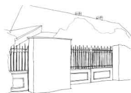
Murs de clôture en pierre enduit avec un portail en ferronnerie
