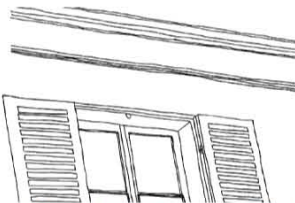
Les tableaux des fenêtres sont traités de la même façon que le mur de façade, enduits, s'ils sont en moellon. Les tableaux en pierre de taille sont simplement rejointoyés
