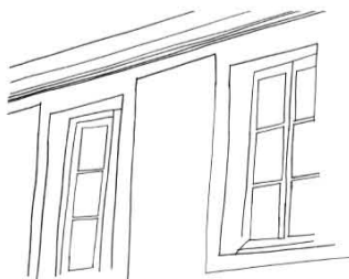
Encadrements de baie et bandeau en enduit de finition lissée
