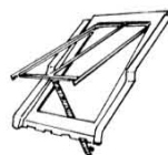
Châssis à tabatière, fenêtre de toit traditionnelle présente sur le bâti ancien, à cadre léger dont l'ouvrant est à projection
