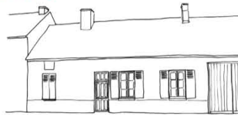
La finition de la façade doit être plane pour laisser la pluie glisser et ne pas accrocher les poussières
