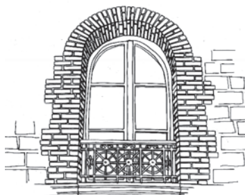
Ouverture avec encadrement en brique, linteau cintré, appui de fenêtre en pierre et garde-corps en ferronnerie
