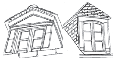
Lucarnes maçonneries en pierre, en bâtière pour la première et capucine pour la seconde
