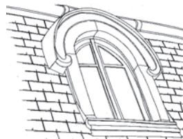
Lucarne en bois protégée par du zinc, encastree dans un toit d'ardoise à la mansard
