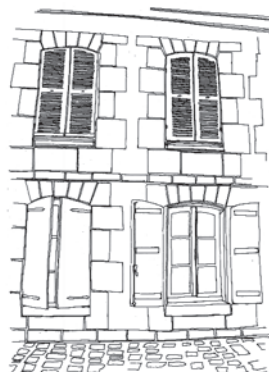
De grosses pierres de taille structurent les murs de façade
