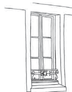
Fenêtre avec un encadrement en enduit lissé
