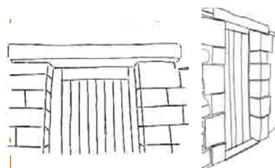
Couronnement d'une dalle de pierre d'une porte piétonne ménagée dans un mur de clôture harpé en pierre de taille
