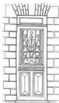
Porte en bois avec partie vitrée protégée par une ferronnerie. Cette porte est caractéristique des maisons 19 ème
