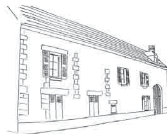
Porche droit ou cintré, porte piétonne, fenêtres de dimensions traditionnelles et lucarnes sont les principales ouvertures composant les façades des maisons de ferme
