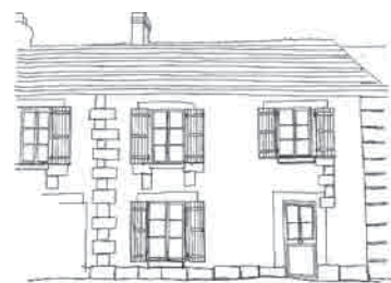
Des chaînages en pierre de taille structurent les murs de la maison de ferme
