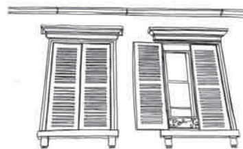
Fermé, le volet est au même nu que la façade, grâce à la présence d'une feuillure dans le tableau maçonné
