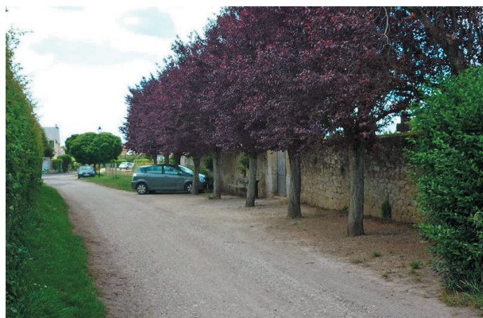
À Barbéry (60), les voitures stationnent sous les arbres, le long du mur d'enceinte du cimetière. Le sol est simplement traité en grave. C'est un aménagement plaisant mais peu favorable aux arbres, du fait du tassement du sol et du risque de blessures des troncs. Planter moins dense aurait permis d'aménager une marge entre arbres et véhicules.
