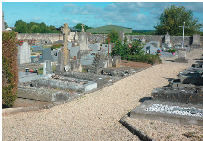
Le revêtement en gravier peut être inapproprié pour le déplacement des personnes à mobilité réduite quand son épaisseur dépasse 3 cm, cimetière de Barbéry (60).
