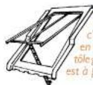
Châssis à tabatière appelé aussi vasistas, c'est une fenêtre pour toit en pente, à cadre léger en tôle galvanisée dont l'ouvrant est à projection
