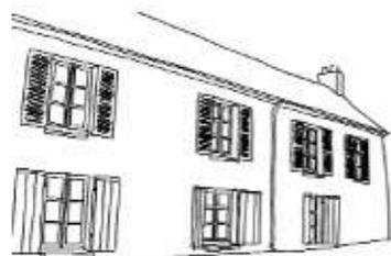
Les ouvertures des maisons de village sont ordonnées suivant l'axe vertical et l'axe horizontal des 2 niveaux
