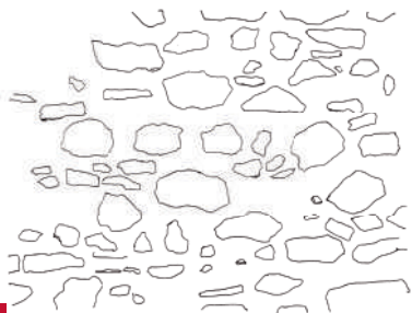
Mur en moellon rejointoyé au nu de la pierre
