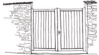
Portail en bois encadré par des murs hauts en moellon protégés par un rang de tuiles
