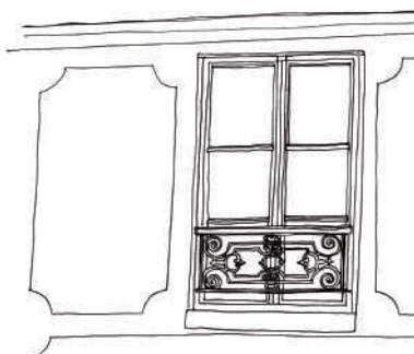
Percement en façade agrémenté d'encadrement, de tables et de bandeaux en enduit lissé
