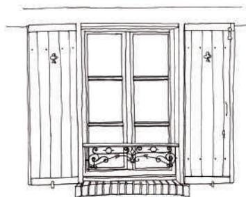
Baie caractéristique d'une maison de bourg, à deux vantaux avec division à trois carreaux égaux
