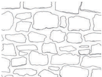
Appareillage d'un mur de clôture en moellon grès et calcaire
