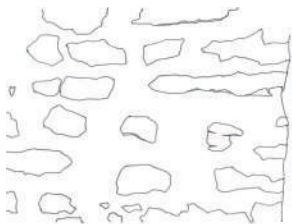
Mur de façade en moellon grès et calcaire rejointoyé à pierre vue
