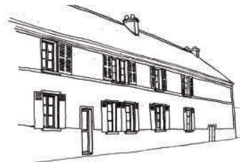
Les linteaux et appuis des fenêtres sont alignés
