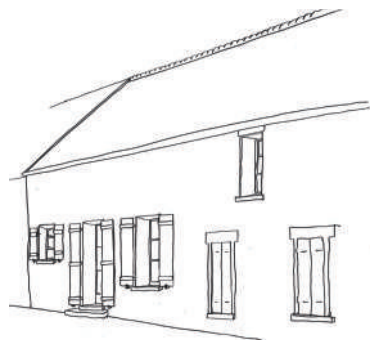
Les ouvertures des longères sont disposées sans ordonnancement précis sur la façade. Leurs linteaux ne sont pas tous alignés horizontalement
