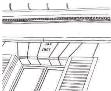
Corniche avec des denticules et encadrement à claveaux
