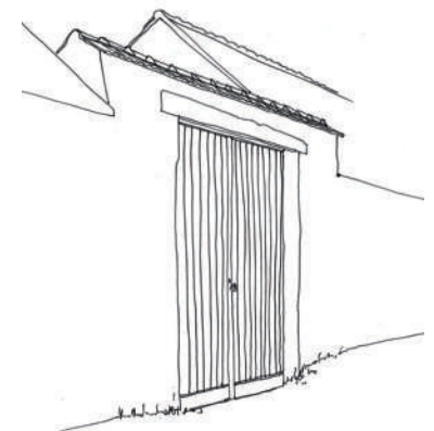
Porte charretière en bois à deux vantaux préservée par un petit chapéon de tuiles
