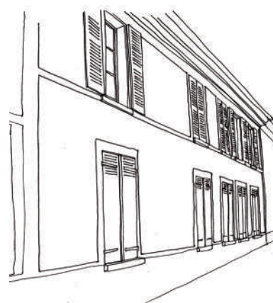
La maison rurale s'élève sur deux niveaux. Les volets sont généralement persiennés sur la moitié de leur hauteur au rez-de-chaussé et en totalité à l'étage
