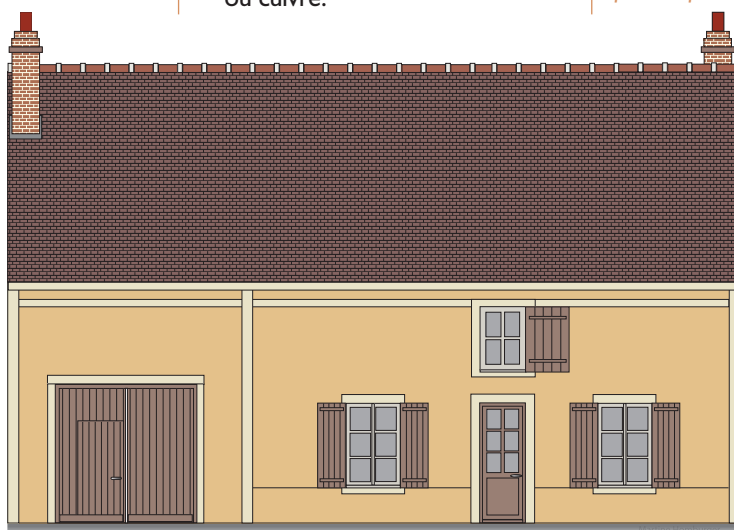
Les maisons rurales ont parfois un étage à encadrement. Les ouvertures sont entourées par des parties en enduit lissé
