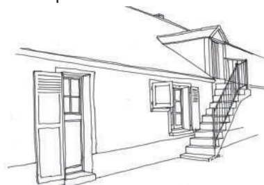
Certains combles de longère étaient accessibles par un escalier extérieur
