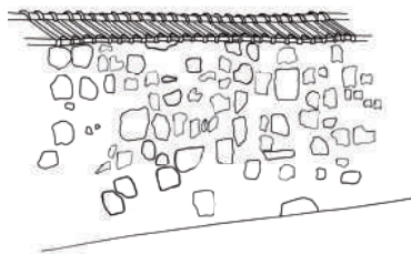
Mur de clôture en moellon grès paré d'un rang de tuile mécanique
