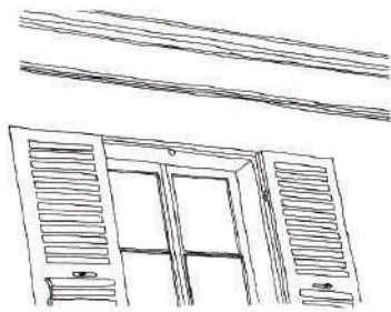
Le tableau des fenêtres et le mur de façade sont enduits lorsqu'ils sont en moellon. Les tableaux en pierre de taille sont simplement rejointoyés
