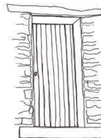
Ancienne ouverture à engranger fermée par un contrevent à un battant
