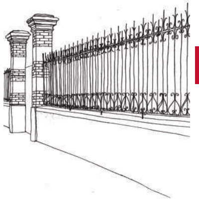
Clôture formée d'un mur bahut surmonté d'une ferronnerie, de piliers en brique et pierre de taille en alternance
