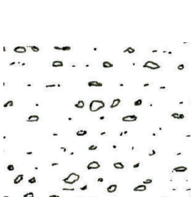
Mur en moellon enduit à pierre vue
