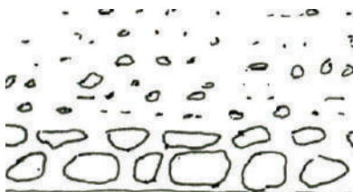
Soubassement en moellon jointoyé à la chaux hydraulique naturelle (NHL 2 ou 3,5)
