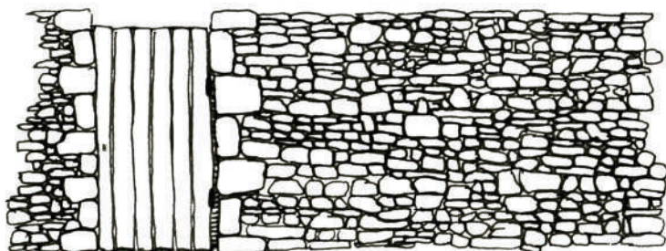
Le mur de moellon calcaire traditionnel présente un appareillage de pierres non assisées, c'est-à-dire ne dessinant pas de lignes horizontales régulières
