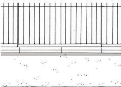
Mur en parpaings enduits et couronnement en pierre
