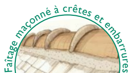
Faitage maçonné à crêtes et embarures
