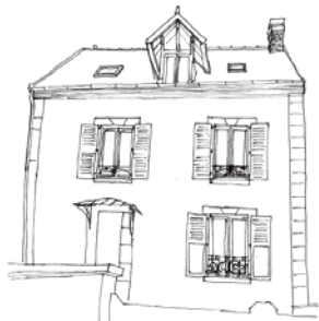
Le volume du toit est parfois aménagé et éclairé par des lucarnes, des châssis...
