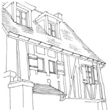
Murs à colombages et lucarnes à capucine
