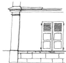
Soubassement en pierre de taille et pilastres en plâtre
