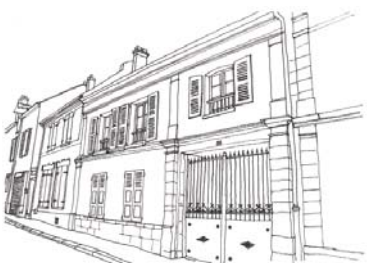
Les maisons de bourg possèdent des éléments de modénature tels que corniche, bandeau...
