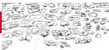
Maçonnerie en moellon non appareillé, rejointoyé au nu de la pierre
