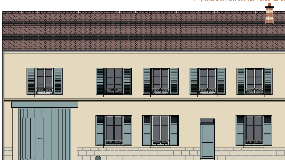
Les maisons de bourg possèdent des éléments de modénature tels que corniche, bandeau...
