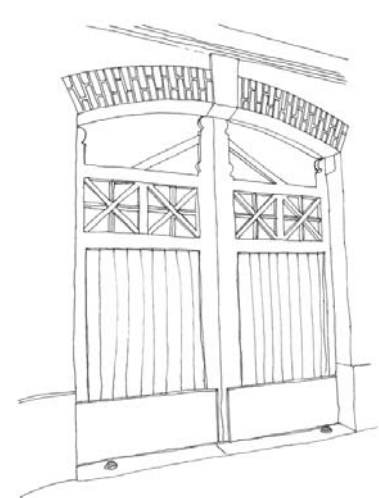
Porche cintré sur porte charretière à deux vantaux en bois plein, mur en pierre
