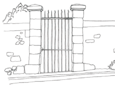
Mur et piles maçonnés avec portail en ferronnerie à barraudage vertical
