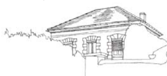
Les modénatures, telles que corniche, encadrement de baie, sont caractéristiques des maisons XIX e
