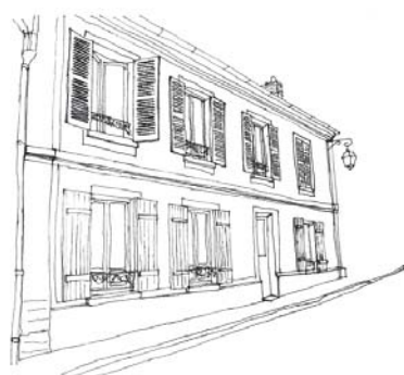
Un soubassement en pierre de taille ou enduit ainsi que des corniches structurent la façade des maisons de village.
