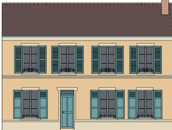
Un soubassement en pierre de taille ou enduit ainsi que des corniches structurent la façade des maisons de village.
