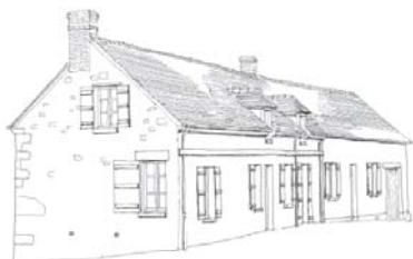
Les linteaux et appuis des fenêtres sont alignés. Les ouvertures en pignon ne sont jamais dans l'axe du faîtage.
