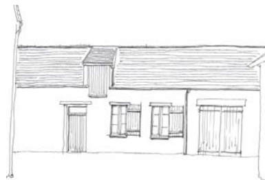
La longère est disposée le plus souvent parallèlement à la voie, parfois en deuxième rideau
