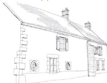
Les ouvertures sont de proportions différentes et paraissent disposées sans ordonnancement particulier. Des chaînages en pierre de taille structurent les façades
