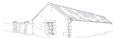
Longère en angle de parcelle, dans le prolongement des murs de clôture. On y accède par un portail sur cour ; sa seule ouverture, en pignon, est désaxée par rapport au faîtage.
