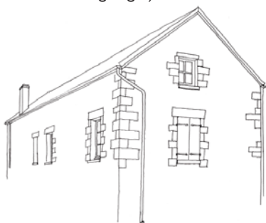
Une fenêtre en pignon, désaxée du faitage, alignée sur celle de l'étage, permet d'éclairer le comble en encuvement
