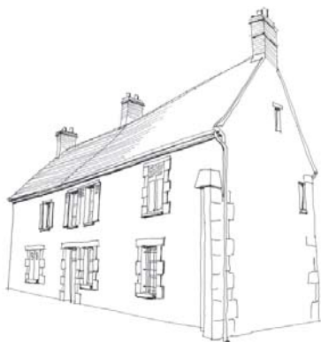
Pile en pierre de taille dans le prolongement du chaînage d'angle de la maison ouverte sur cour
