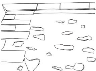
La finition de la façade doit être plane pour laisser la pluie glisser et ne pas accrocher les poussières. Très peu de moellons doivent apparaître
