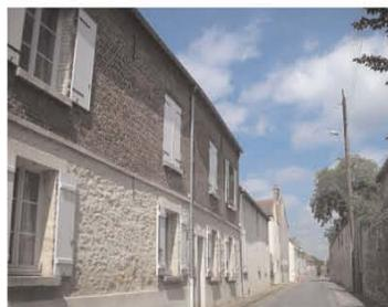
La tuile mécanique, la brique et le moellon calcaire enduit sont les matériaux de construction traditionnels des maisons 19<sup>ème</sup> brique.
