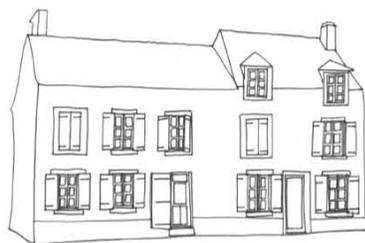
Les ouvertures des grandes maisons sont marquées par les encadrements en pierre, les ferronneries des garde-corps, les feuillures dans lesquelles les volets fermés s'encastrent
