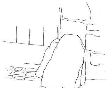
Bornes et de chasse-roues en grès protégeant les angles du mur
