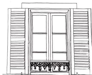
Baie d'une maison de bourg ornée par un garde-corps en fer forgé travaillé
