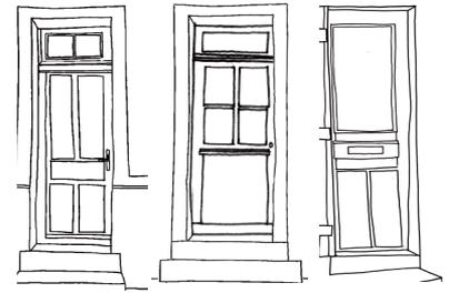
Portes d'entrée avec partie supérieure vitrée protégée par une ferronnerie ou imposte vitrée droite surmontée parfois d'une marquise
