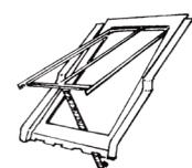
Châssis à tabatière, fenêtre de toit traditionnelle présente sur le bâti ancien, à cadre léger dont l'ouvrant est à projection
