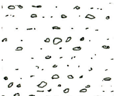
Mur en moellon enduit à pierre vue
