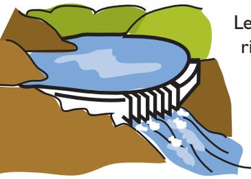
Les barrages sont d'immenses " murs " qui retiennent l'eau d'une rivière. Cette eau s'accumule et forme un lac. Lorsqu'on ouvre les vannes du barrage, l'eau s'écoule à toute **allure**. Elle fait alors tourner un petit moteur appelé **turbine** qui transforme la force de l'eau en **courant électrique**.
