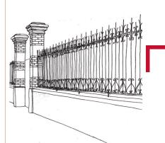
Clôture formée d'un mur bahut surmonté d'une ferronnerie, de piliers en brique et pierre de taille en alternance
