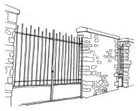
Mur de clôture en pierre avec portail et portillon droit en ferronnerie à barreaudage vertical
