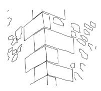
Chaînage d'angle en pierre de taille sur un mur de moellon enduit
