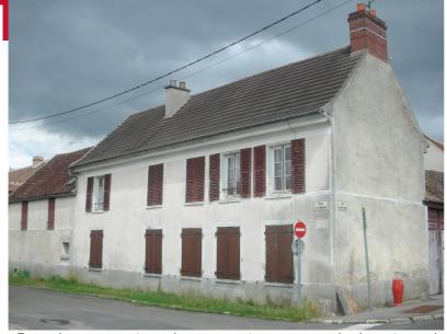
Des volets persiennés sur la partie supérieure au rez-de-chaussée, sur la totalité à l'étage, occultent les fenêtres des maisons de bourg. Les ouvertures de l'étage sont agrémentées de garde-corps en ferronnerie. Des modénatures en finition lissée ornent les murs sur rue. Une corniche en plâtre souligne la liaison entre le toit et le mur.
