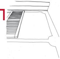
Mur de façade avec table enduit, encadrement et bandeau lissés
