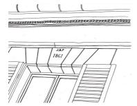
Corniche avec des denticules et encadrement à claveaux
